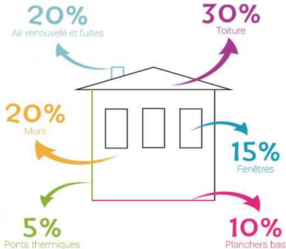
Répartition moyenne des pertes de chaleur dans les logements d'avant 1974 non isolés
